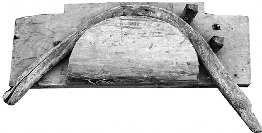
Рис. 54. Устройство для сгибания дуги. Фотография предоставлена А.А. Гануличем
