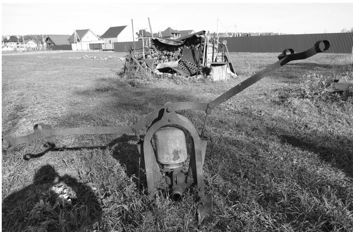
Ручной пожарный насос (в рабочем состоянии)
